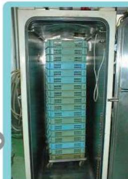
真空冷却で急速冷却
